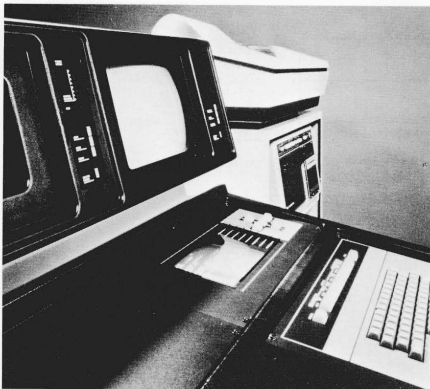
図9 M-003の操作パネル M-003は二つのCRTモニターとフルキーボード、メイン/ディティールファンクションセレクトタなどにより、対話形式で操作する。
