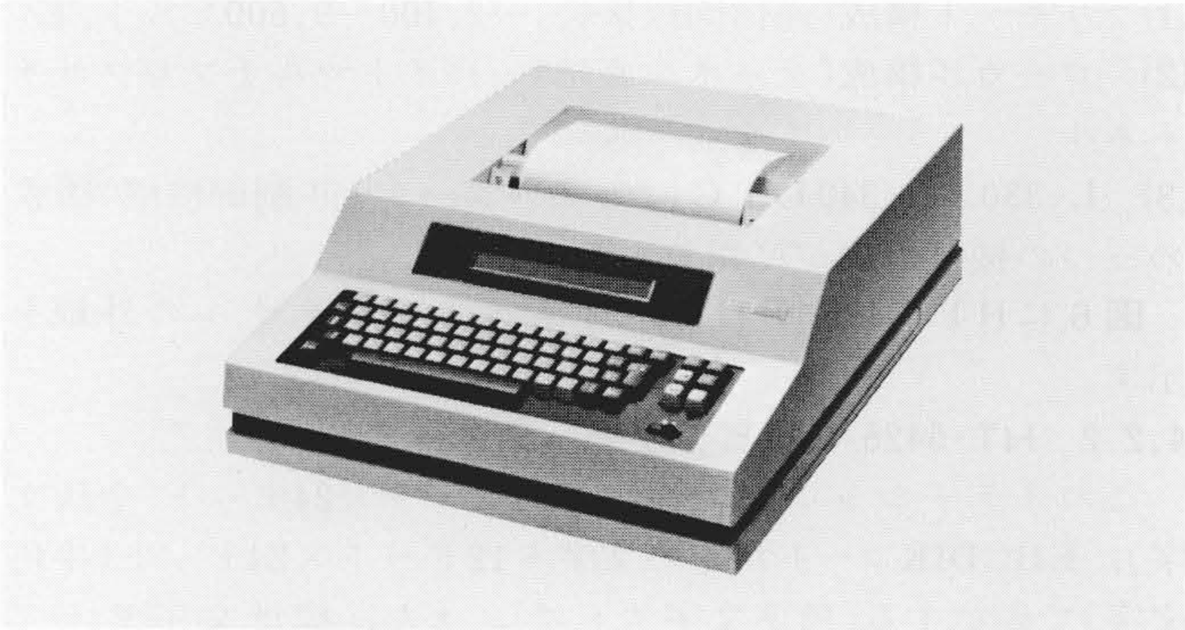
図7 HT-5217漢字プリンターミナルの外観〔幅420×奥行500×高さ130(mm)〕 無制御手順で接続可能な小形、軽量(15kg)ターミナルである。
