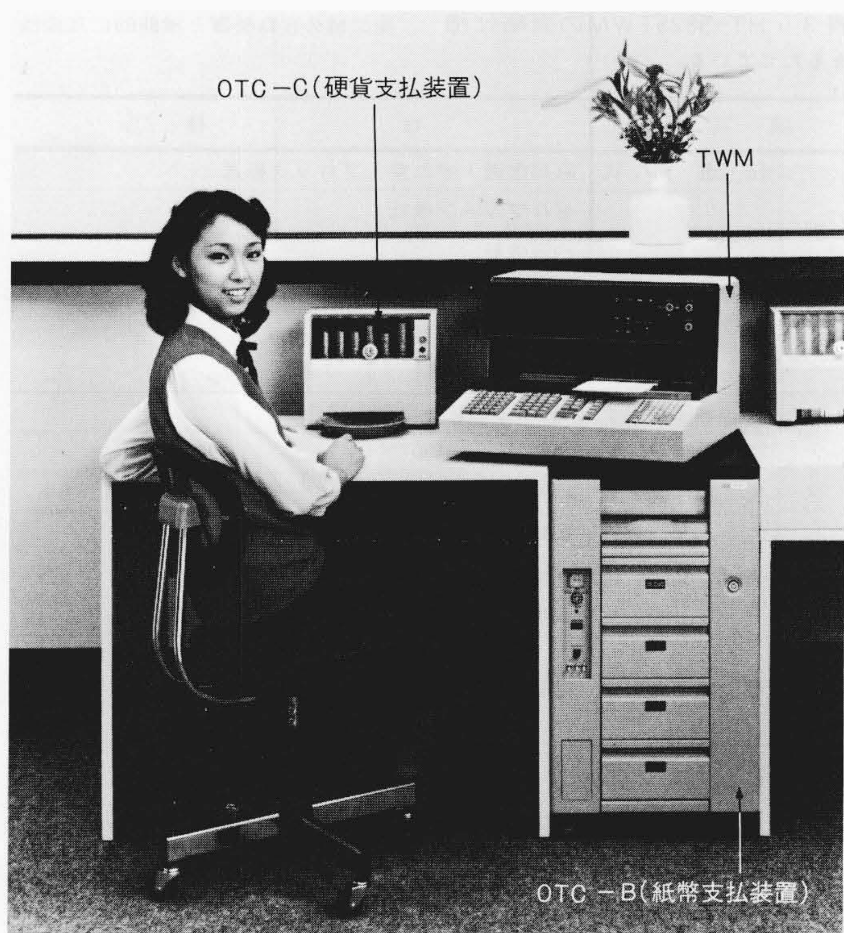
図7 HT-5825TWM(テラー窓口装置)の外観 通帳印字機構を一体化し、OTC-B(紙幣支払装置)、OTC-C(硬貨支払装置)を接続可能とした。
