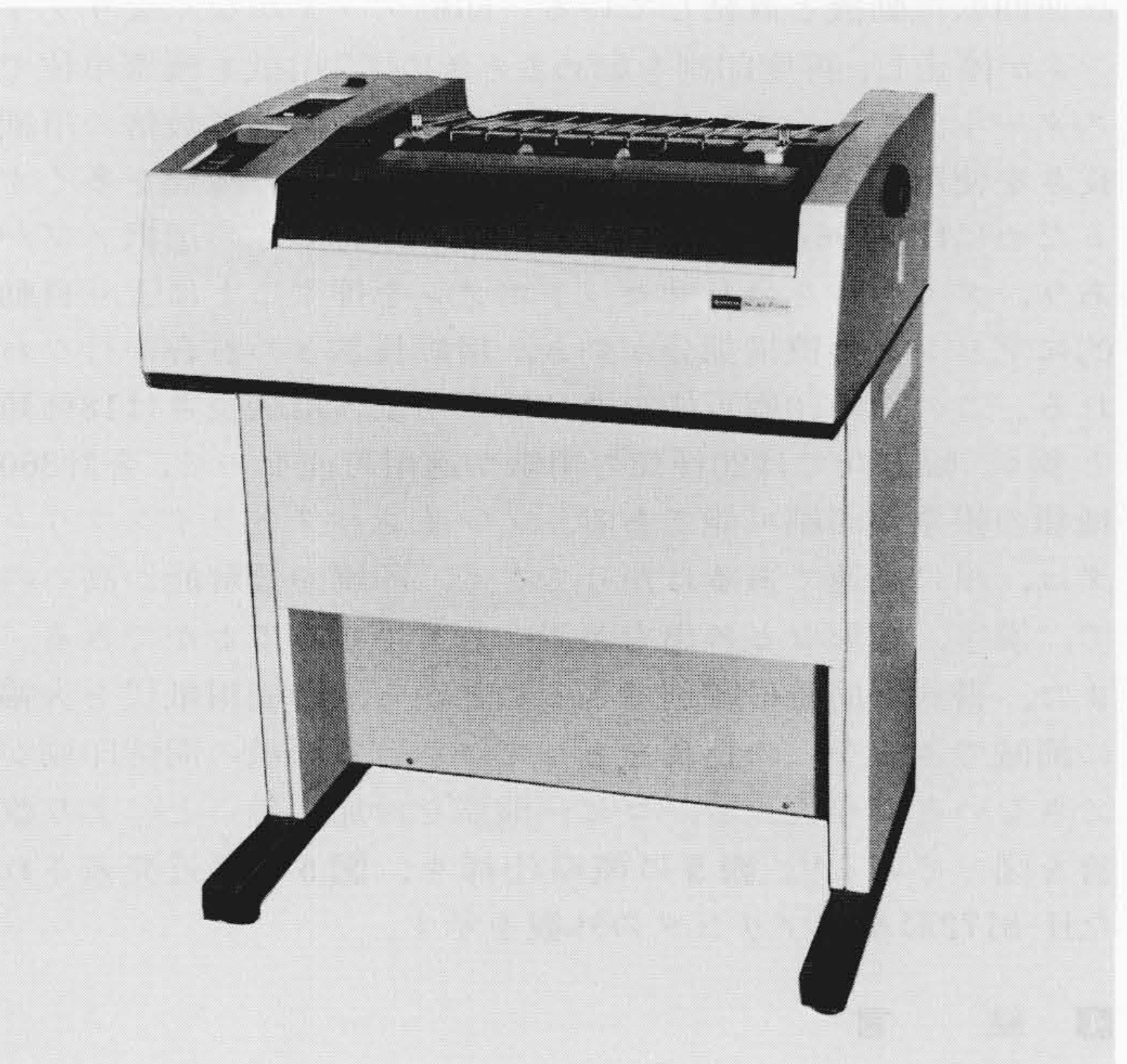
図4 HT-5353プリンタ 85文字/秒の高速で漢字も印字できるインクジェットプリンタである。
