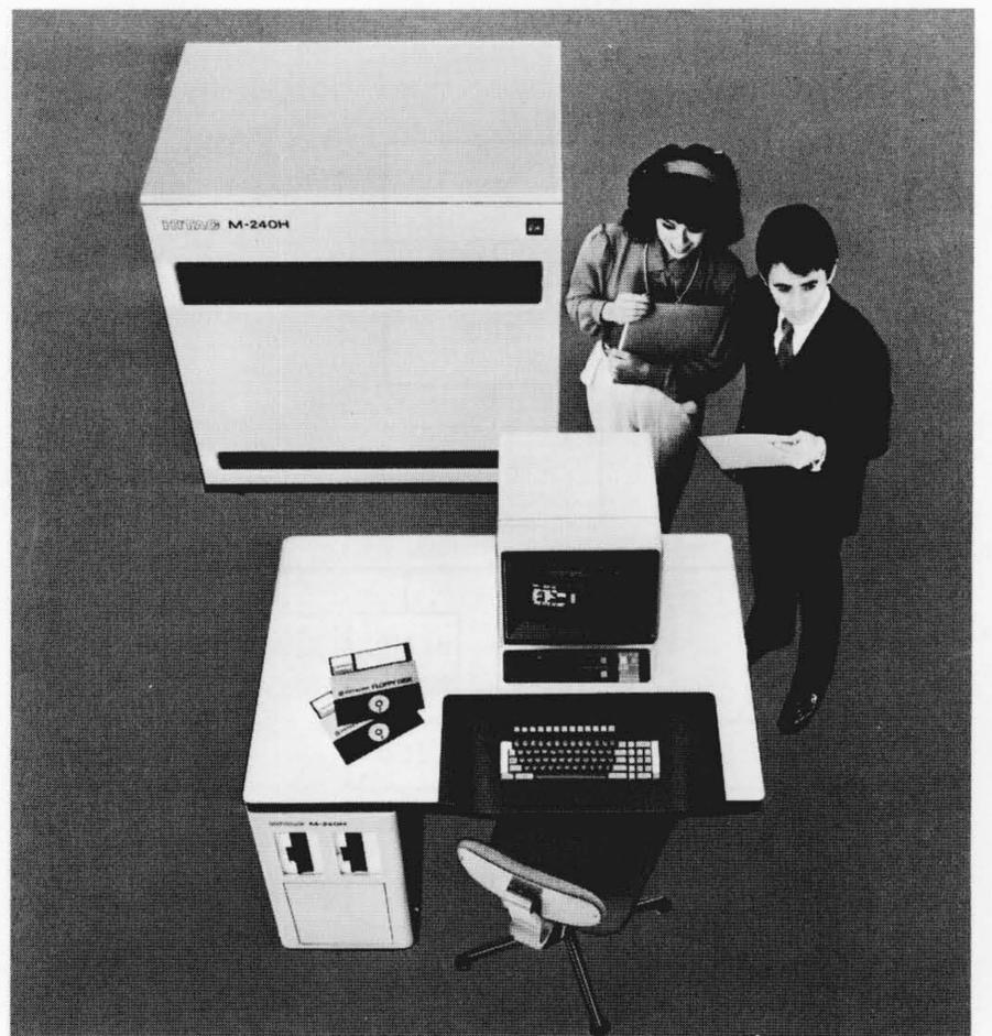
図1 HITAC M-240H処理装置の外観 中央処理装置1台につき、最大8Mバイトの主記憶、最大8台のチャンネルでシステムを構成できる。
