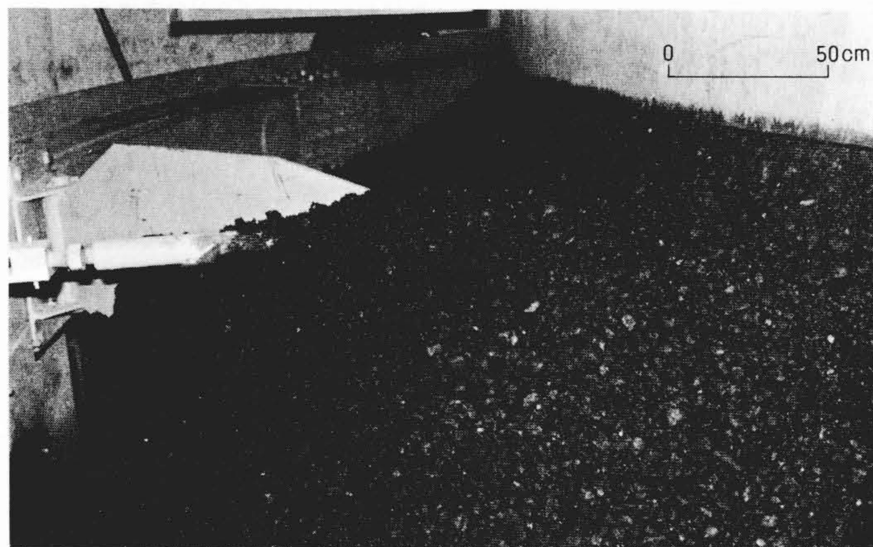
図8 払い出しの状況 固定テーブル上へ流出した石炭は、回転スクレーパにより下側へ払い落とされる。
