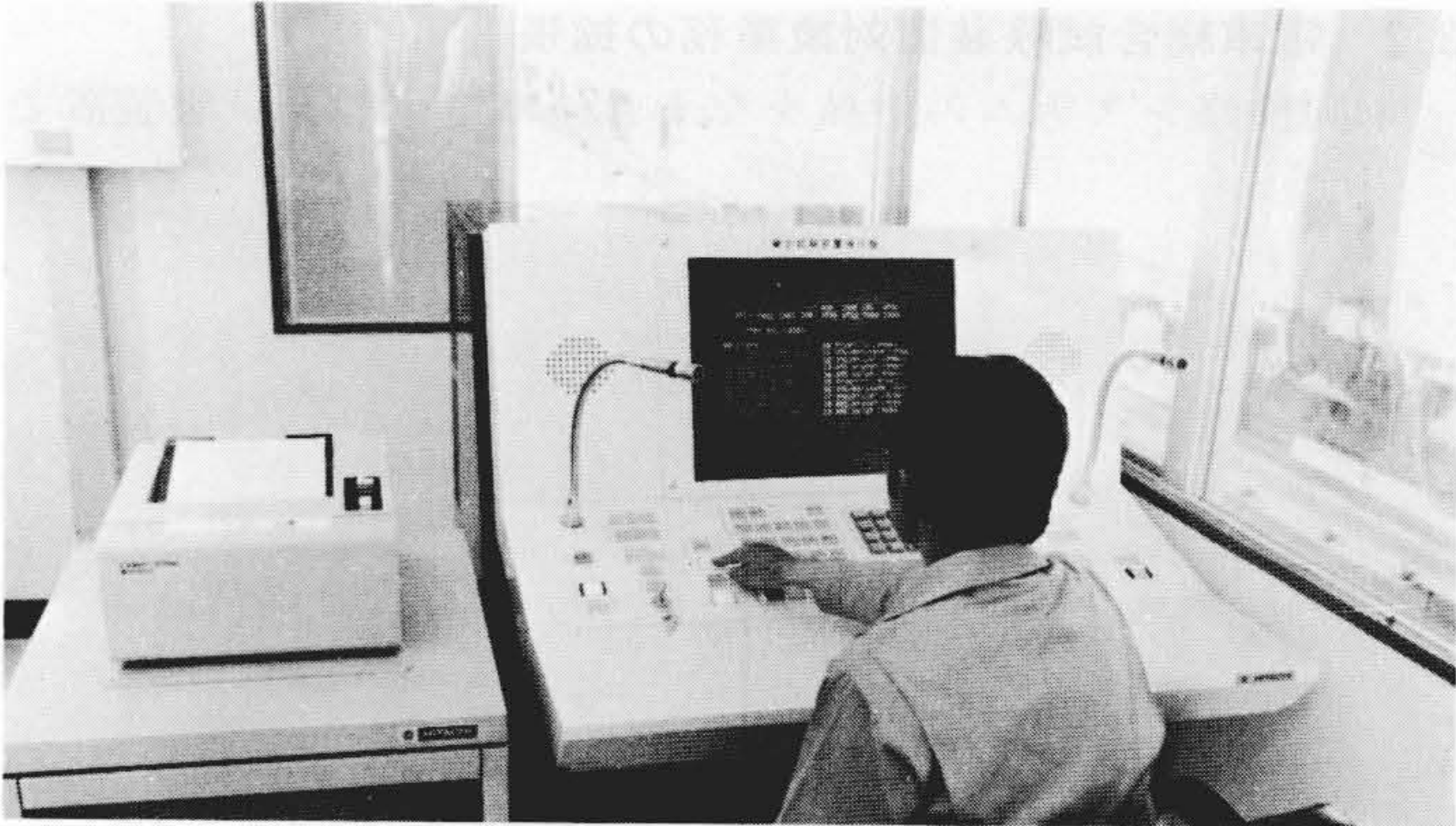
図6 操作盤による試験実行状況 試験の実行状況、結果は、カラーディスプレイ装置に表示され、必要に応じてハードコピー装置でコピーをとることができる。
