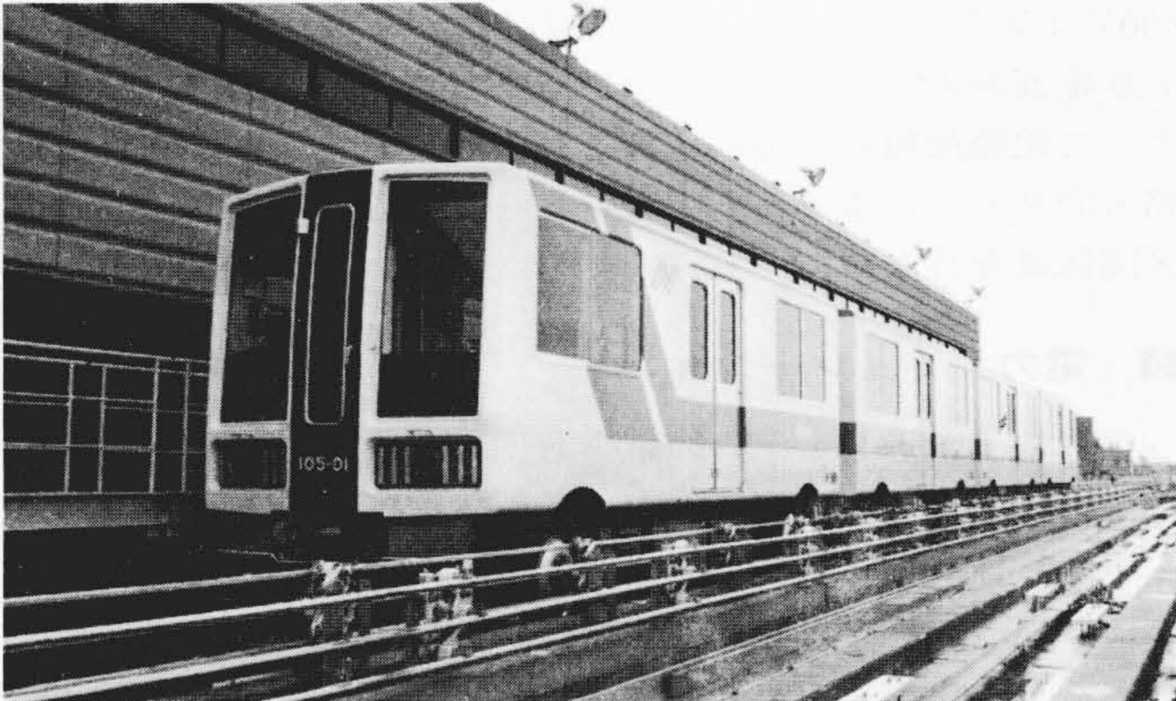
図1 南港ポートタウン線の車両 車体は耐食性に優れた高耐候性圧延鋼材を使用し、板厚を薄くすることによって軽量化を図っている。
