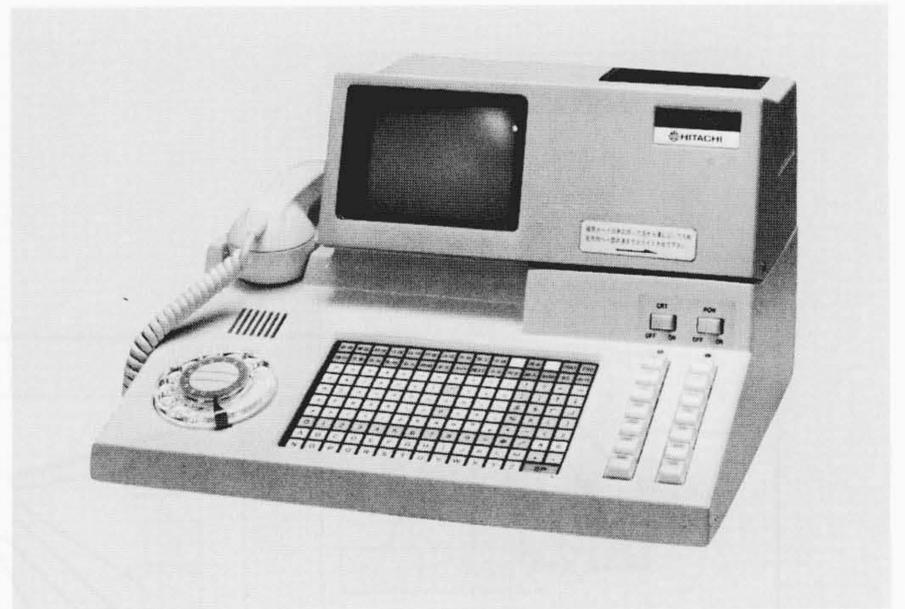
図7 メモフォン外観 電話機の機能以外に、仮名文字、英・数字及び記号の編集表示用5inのCRT、プリンタ、習熟不要な感圧式キーボード、磁気カードリーダーなどをもち、テキストメール機能、インテリジェント電話機能の実現を図っている。
