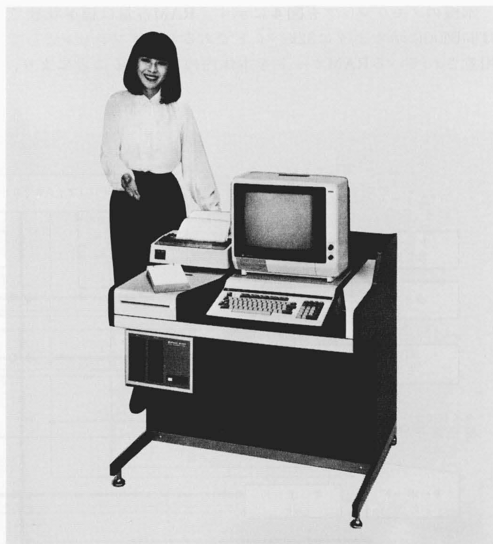
図2 ベーシックマスターレベル3システムの外観 標準の入出力装置であるカラーディスプレイ、10インチプリンタ及び5インチミニフロッピーディスクを収納するシステムデスクも用意されている。
