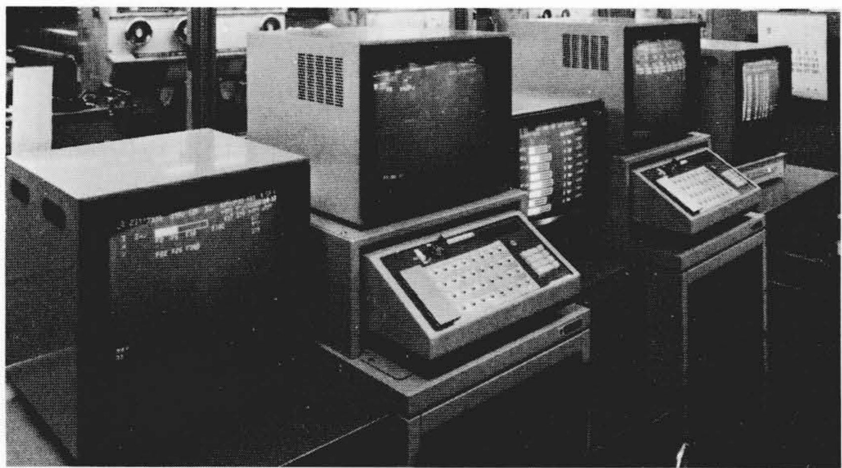
図10 マンマシンインタフェースとしての新操作端末(左から2, 4 台目) 操作性に優れた入力部と可視性に富んだカラーCRTを組み合わせた端末で、このシステムのマンマシンインタフェースの中心的役割を果たしている。
