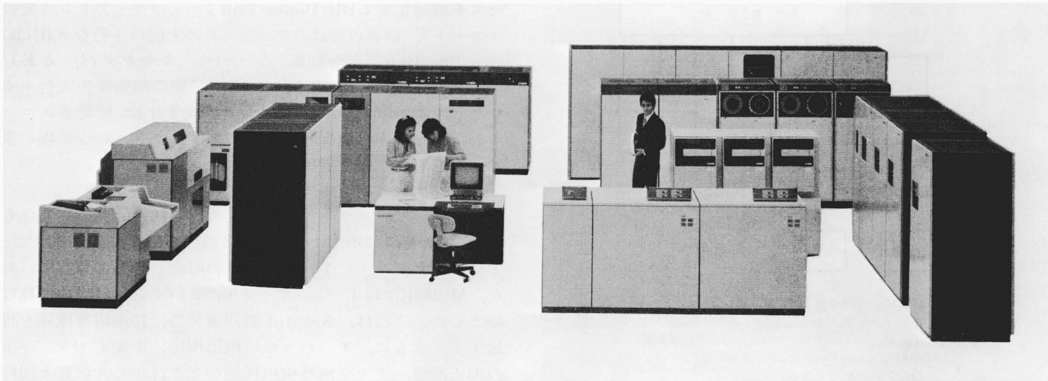
図1 HITAC M-260Hシステム外観 M-260Hの主記憶容量は、最大24Mバイト、チャンネル数は最大24台まで拡張可能である。
