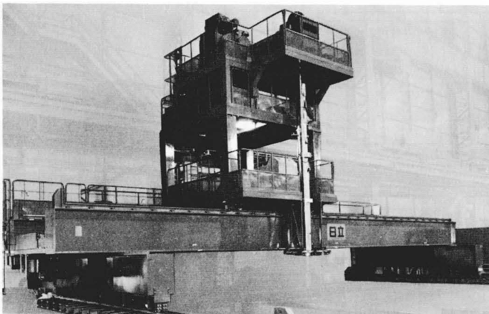
図7 自動燃料取替機 最新式の自動燃料取替機の工場内組立状態を示す。
