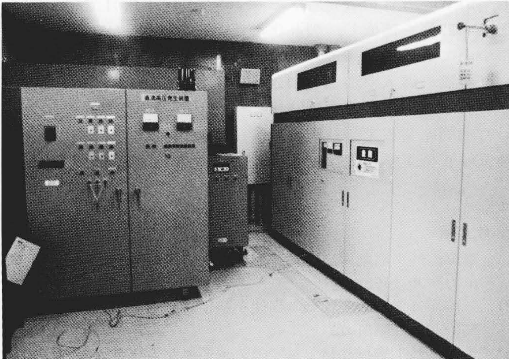
図11 5kW CO 2 レーザ装置の外観 加工室入口側から見た加工室・発振器、制御盤などの状況を示す。
