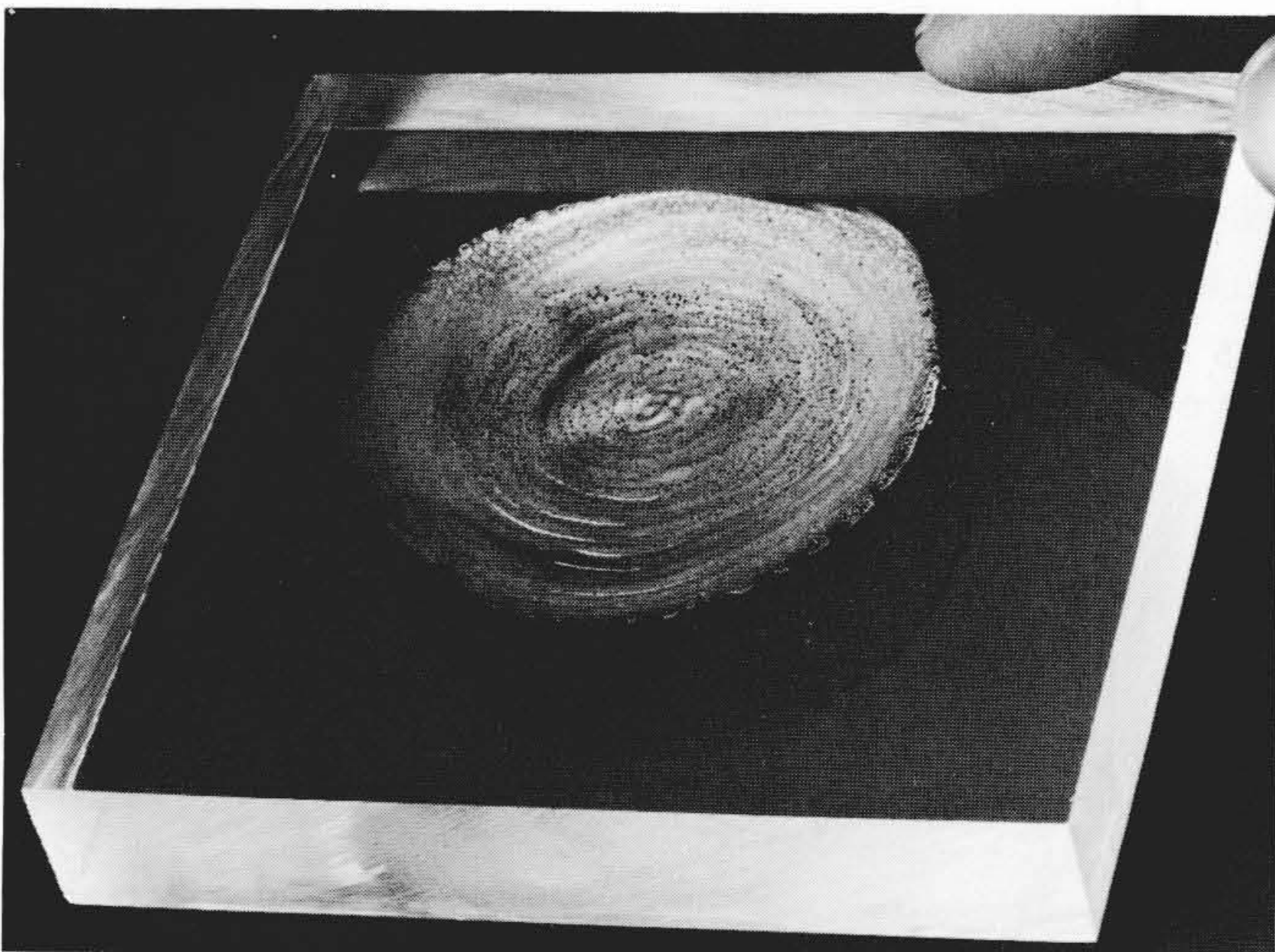
図8 バーンパターン 安定形共振器のため、出力鏡端から加工ヘッドまで、良好な円柱形をしたマルチモードのレーザーが出力されている。
