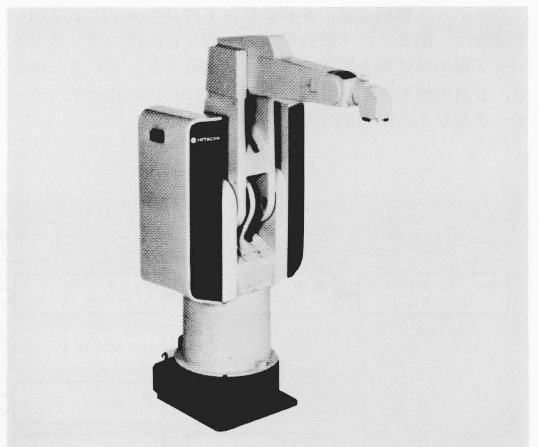
図1 組立ロボットの外観 — 各軸の駆動電動機をベース部に集中した軽量構造とした。
