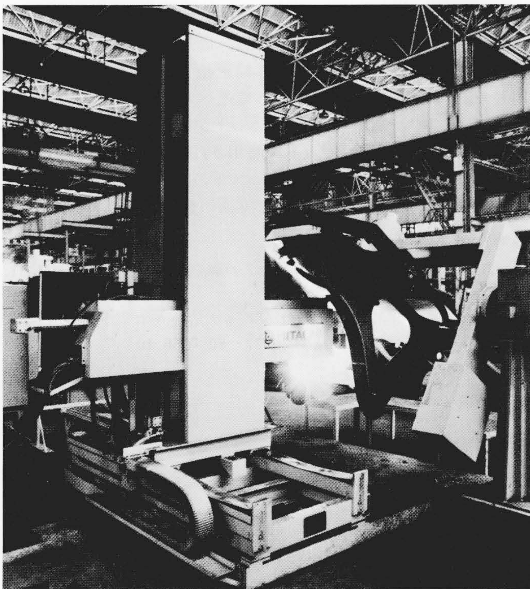
図6 クランク形2軸サーボポジションナとの協調運転 複雑な形状のワークの溶接にはロボットだけでは自由度が不足するため、ポジションナに自由度をもたせてこれを補う。
