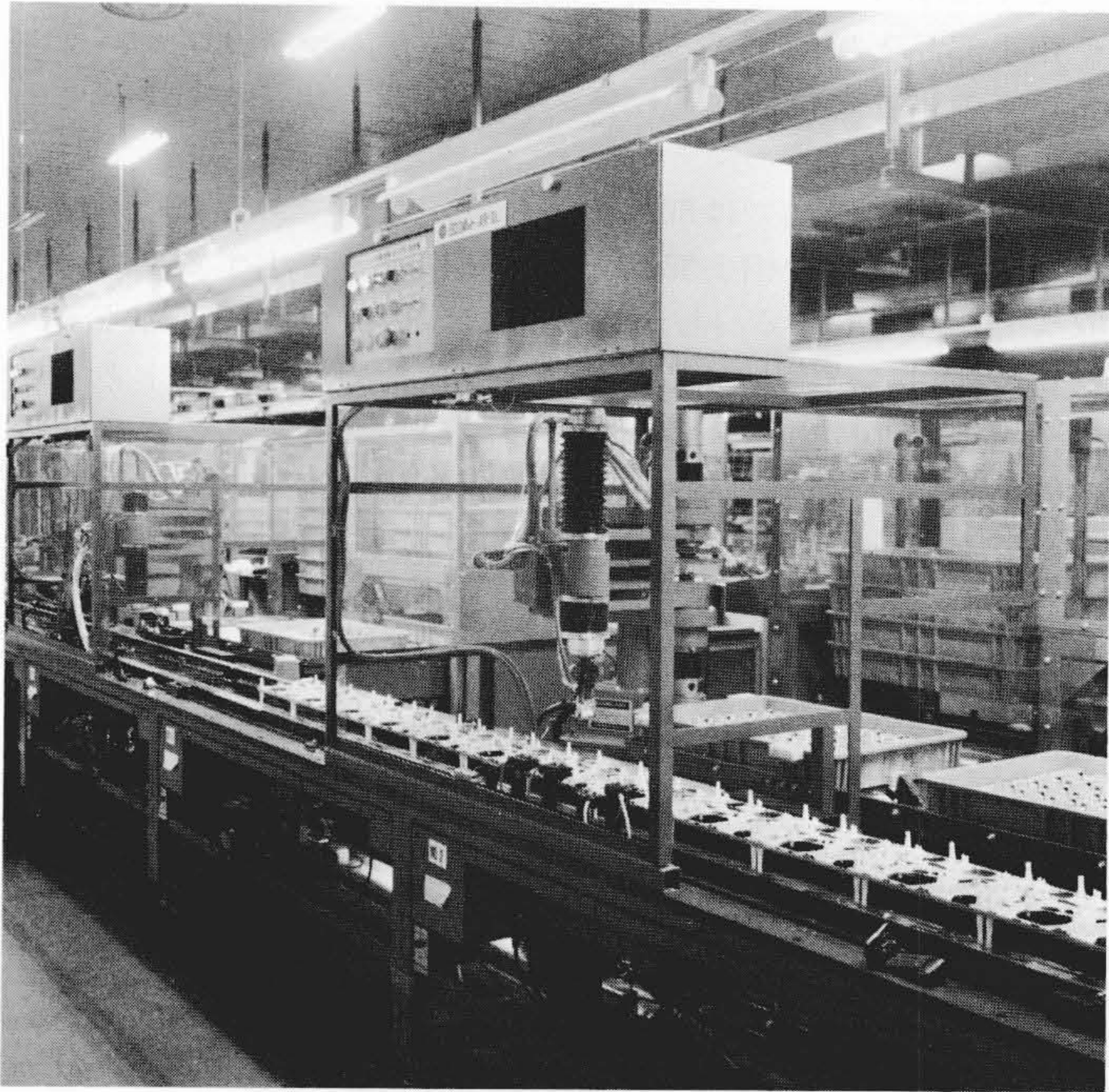
図4 ロボットステーションの外観 本組立ラインには、簡易形組立ロボットが11台導入されている。
