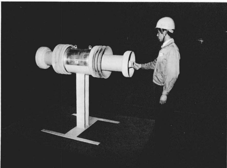
図10 多重バリヤ絶縁リード線 本リードの使用により、高压リード線のポケットやリードダクトへの引出部寸法が大幅に縮小できた。
