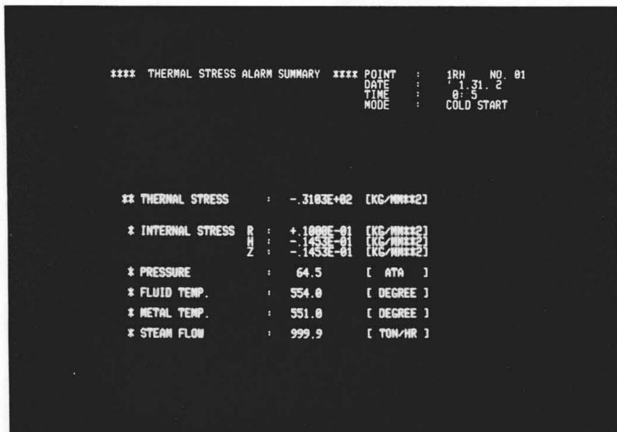
図11 熱応力アラームサマリ表示 熱応力計算値がアラーム設定値を超えたとき、熱応力値と関連データをプロセスカラーディスプレイにリスト表示し、アラームの原因を追求することができる。
