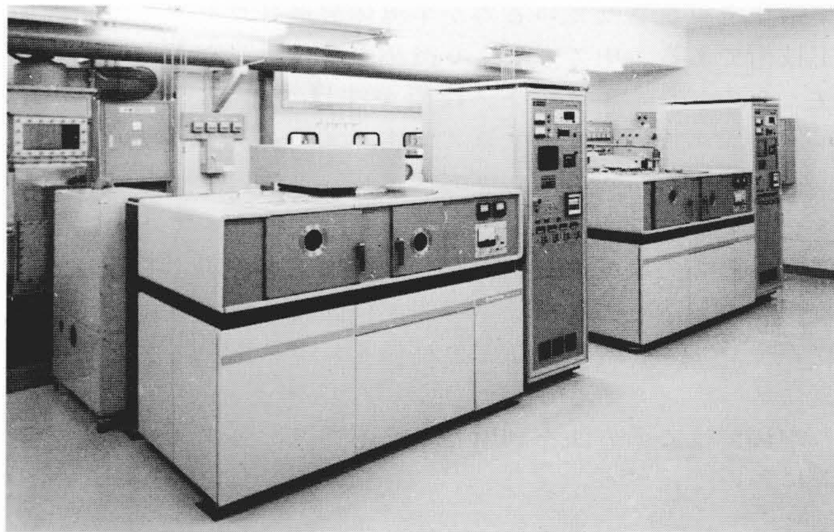
図4 反応性スパッタエッチング装置の外観 デモンストレーション展示室に設置された装置であり、手前がSiO 2 用、奥がAl用のエッチング装置である。
