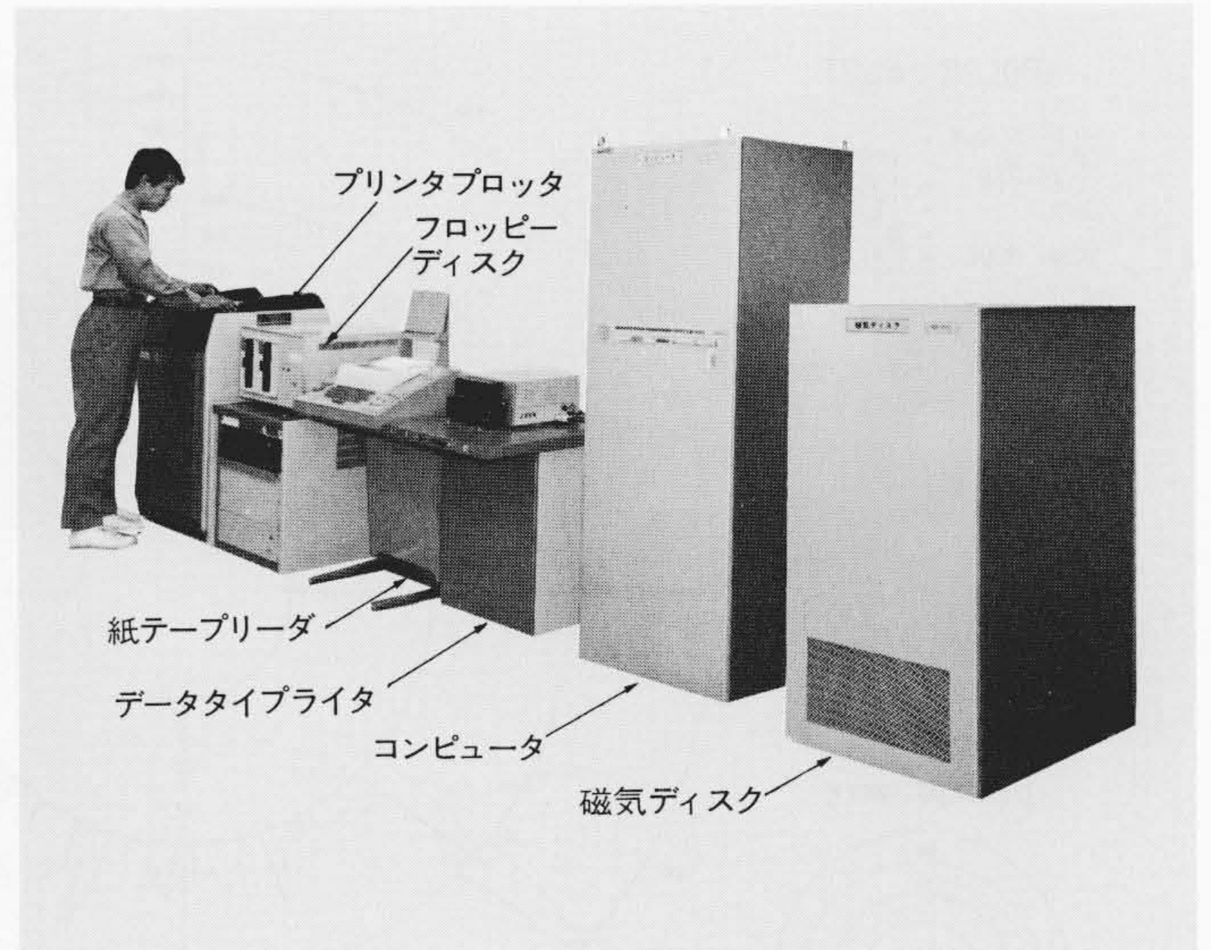
図10 データ処理装置 オフラインによりデータを処理する。左からプリンタプロッタ, フロッピーディスク, 紙テープリーダー, データタイプライタ, コンピュータ及び磁気ディスクを示す。
