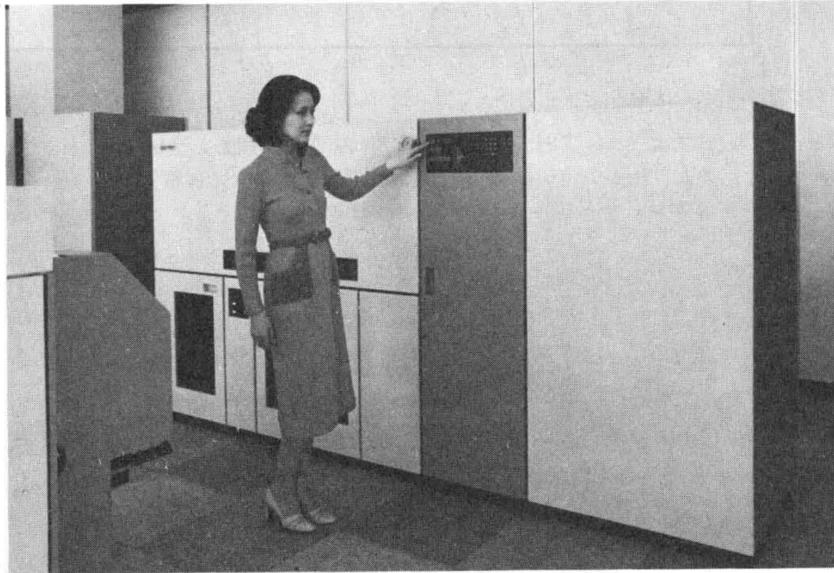
図7 H-8196-30漢字プリンタ 1分間に1万5,200行を印刷する漢字プリンタである。
