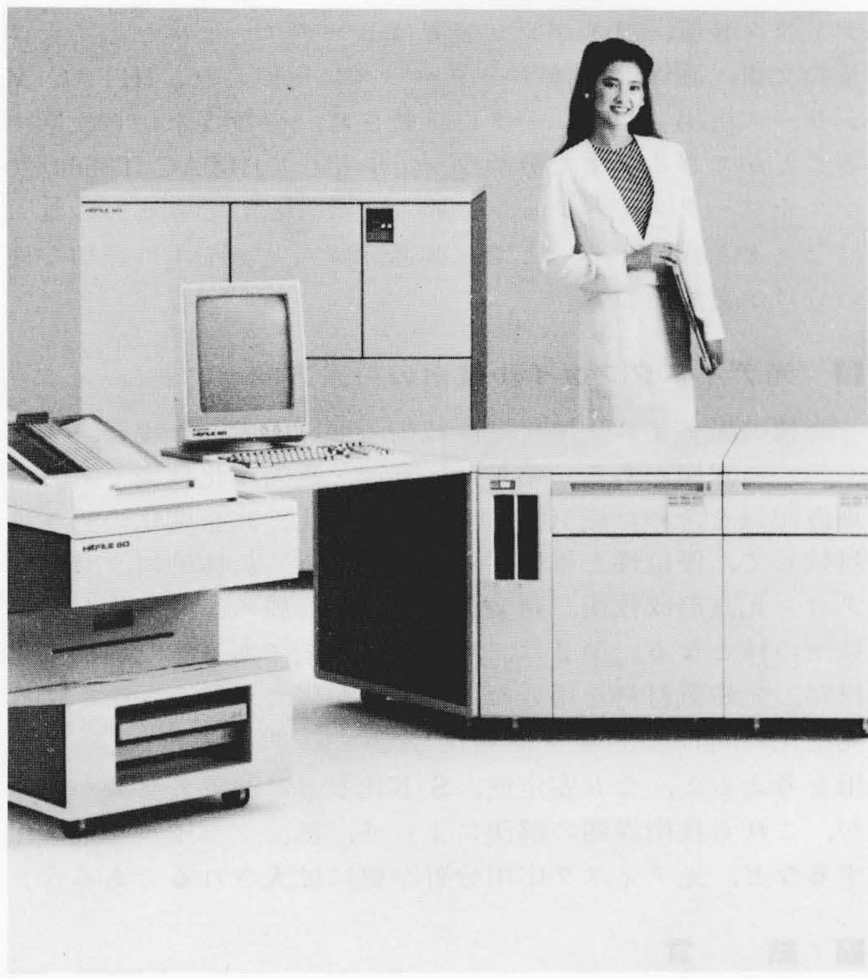
図9 光ディスクファイルシステム“HITFILE60”の外観 入出力装置、ディスプレイ装置を備えている。
