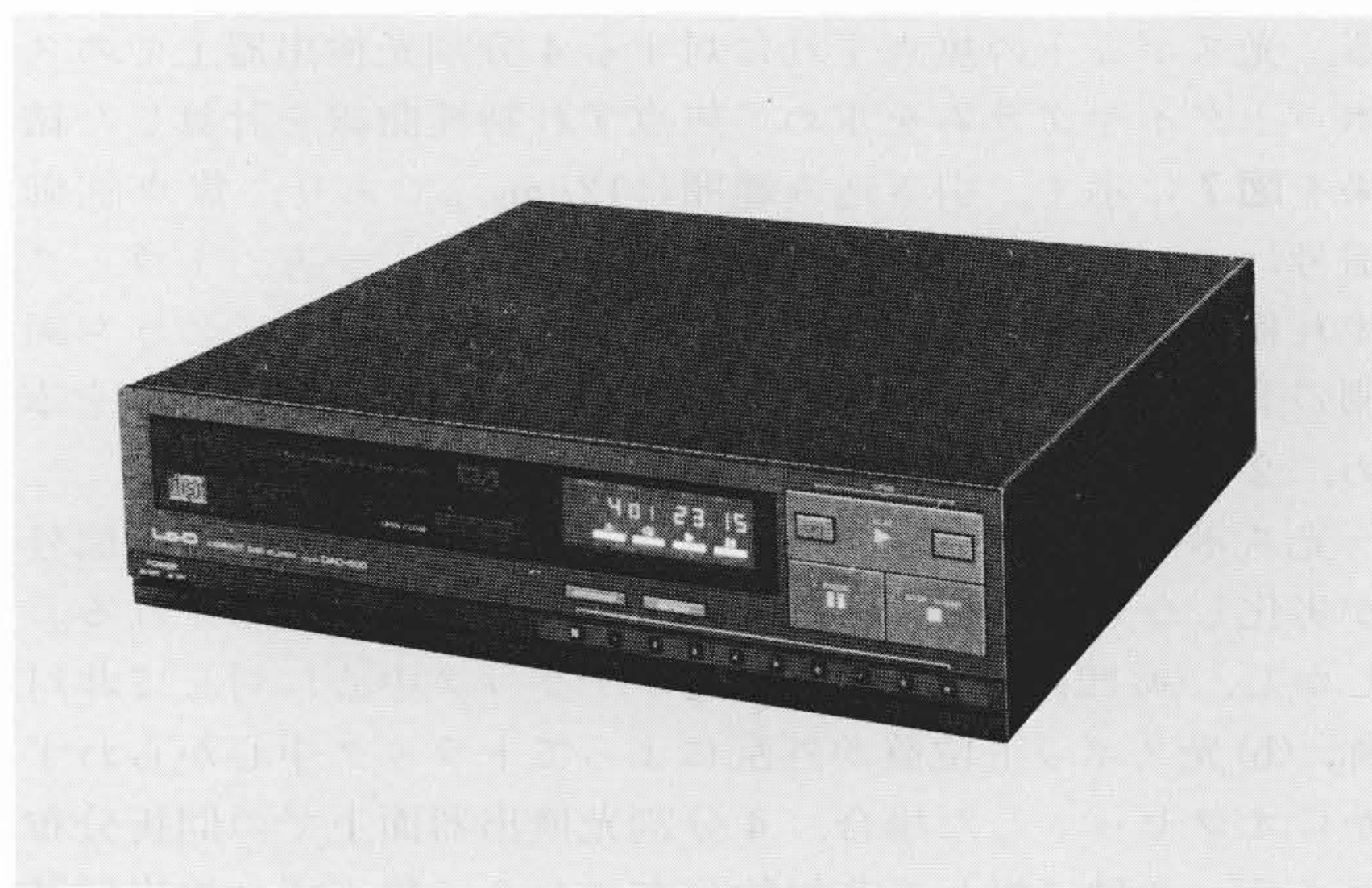
図11 コンパクトディスクプレーヤ(DAD-3000) 従来のアナログプレーヤでは望み得なかったダイナミックレンジ95dB, SN比95dB, 高調波ひずみ率0.003%という高性能を達成し、より高忠実度再生が可能になるとともに、自動ディスク装着装置、任意曲を任意順に演奏するプログラム演奏機能、演奏曲番、演奏経過時間表示装置など、多くの使い勝手の良い機能が備わっている。
