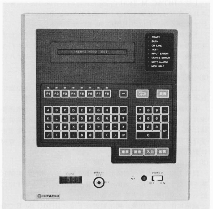
図4 データターミナルの外観 物流作業現場では、このデータターミナルによって各種の作業要求を行なっている。
