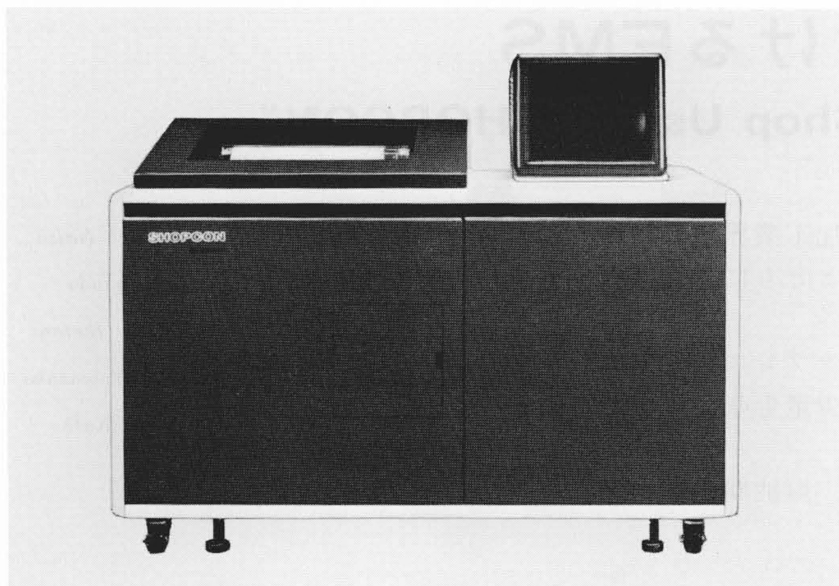
図2 SHOPCONの外観 防塵きょう体に、中央処理装置(メインメモリ256kバイト)、漢字コンソールCRT、プリンタ、固定板ディスク40Mバイト、フロッピーディスク1Mバイト×2ドライブが一体化して実装されている。
