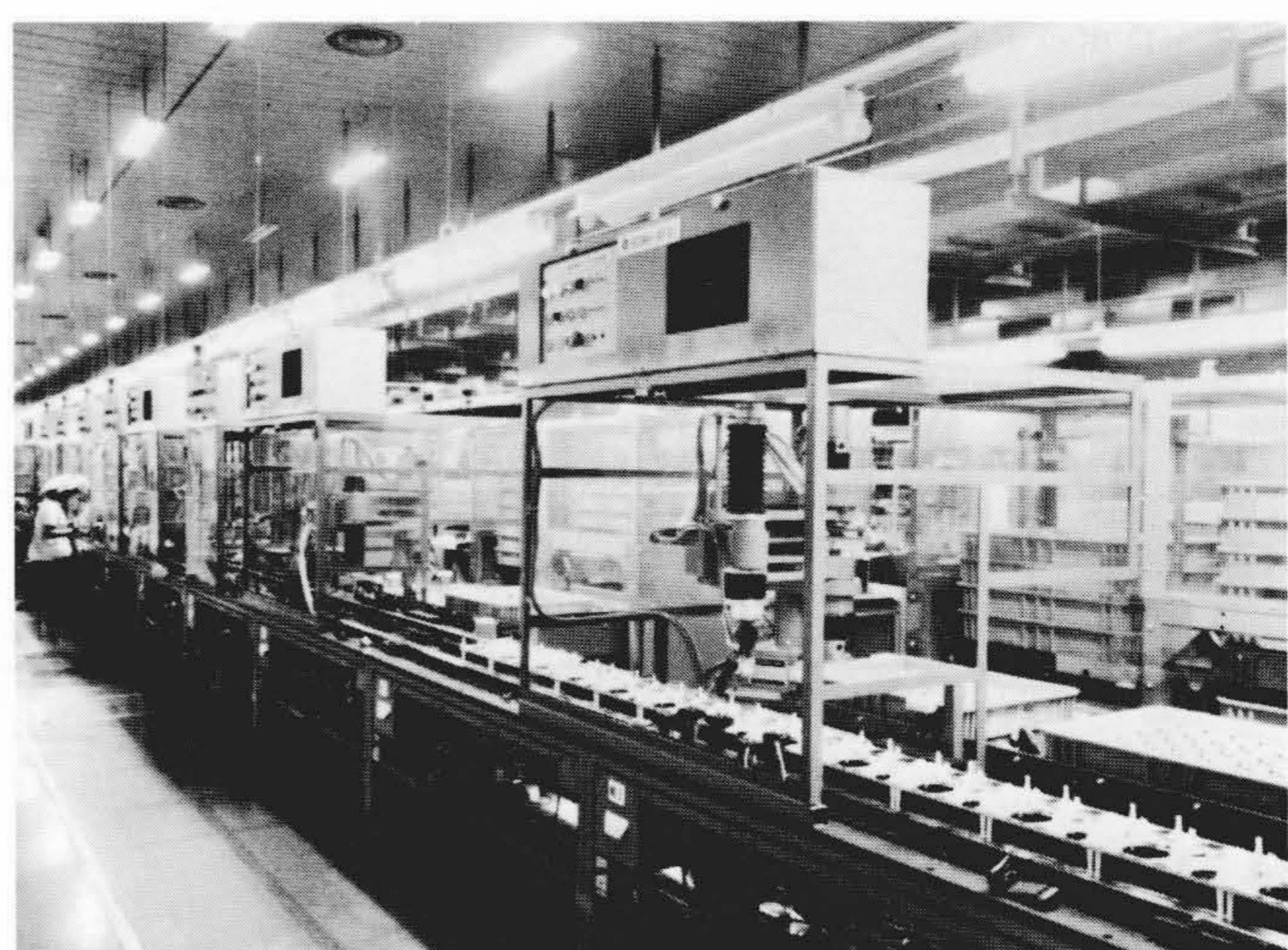
図14 VTRメカニズム自動化ライン外観 本自動化ラインには、組立ロボットA3020が11台導入されている。
