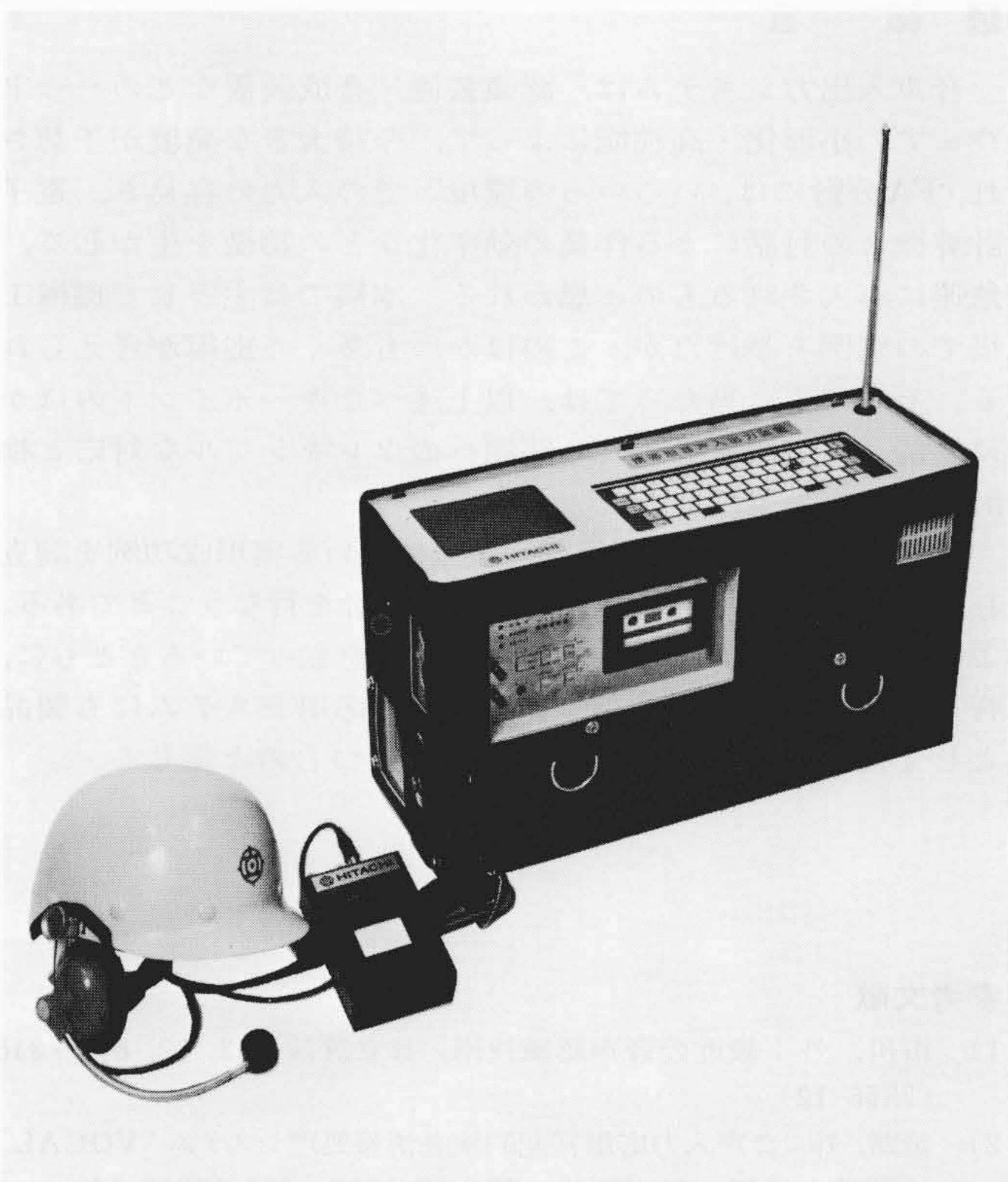
図5 音声対話形鋳造品検査システムの実例 ポータブル形音声入出力装置を、現場へ持ち込んで作業を行なう。
