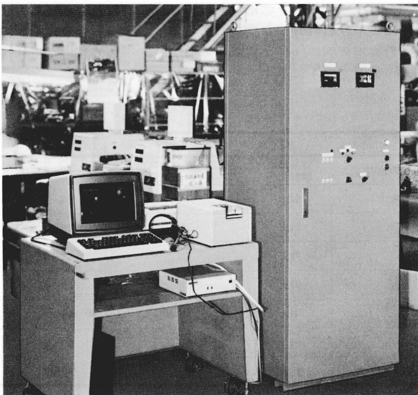
図2 音声対話形立体倉庫の入出庫管理システムの実例 立体倉庫のリフトの運転者が、リフトの運転を行ないながら音声入力を行なう。
