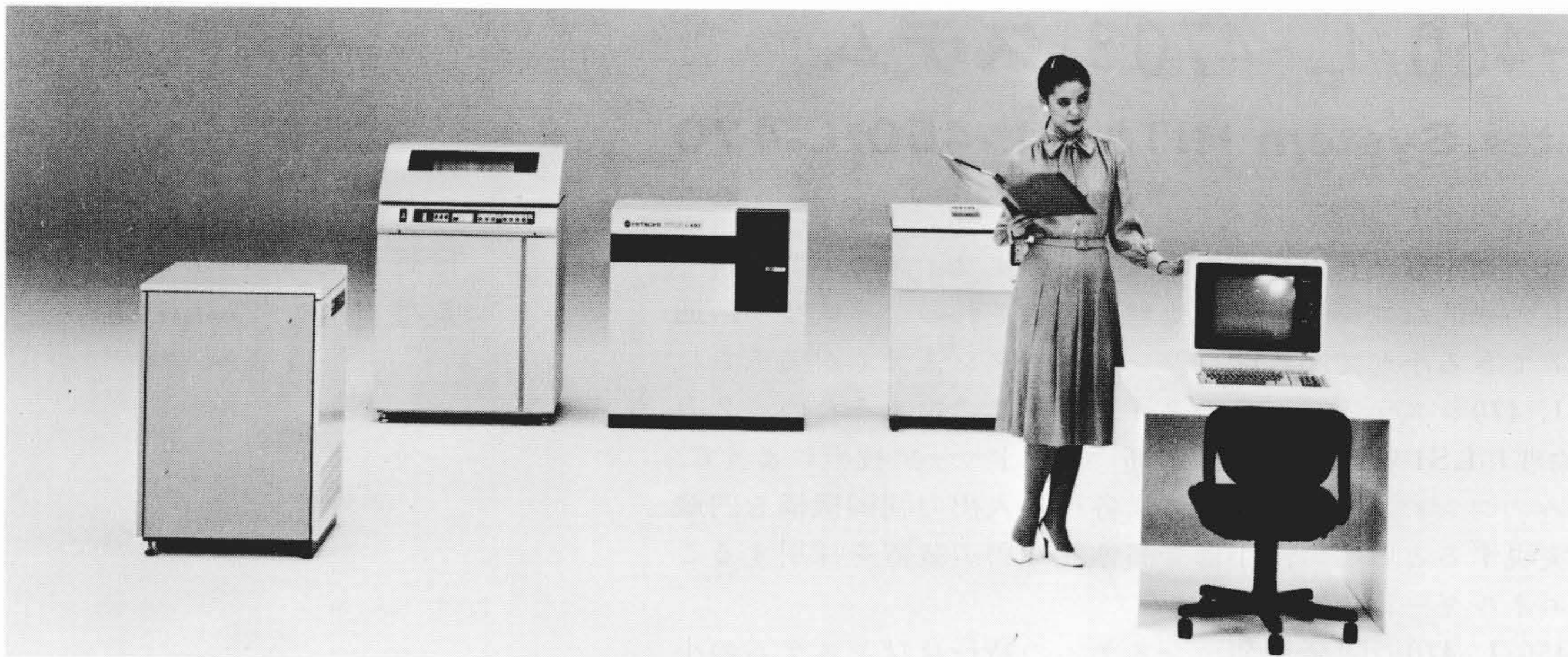
図1 HITAC L-450システムの外観 オフィス環境への適合性の高い、コンパクトで高性能なシステムである。写真左からディスク駆動装置、漢字ラインプリンタ、処理装置、磁気テープ装置及びビデオデータターミナルを示す。処理装置には、最大2Mバイトの主記憶装置、ディスク制御機構、磁気テープ制御機構、ローカルターミナル制御機構、フロッピーディスク駆動装置、通信制御機構などを内蔵している。
