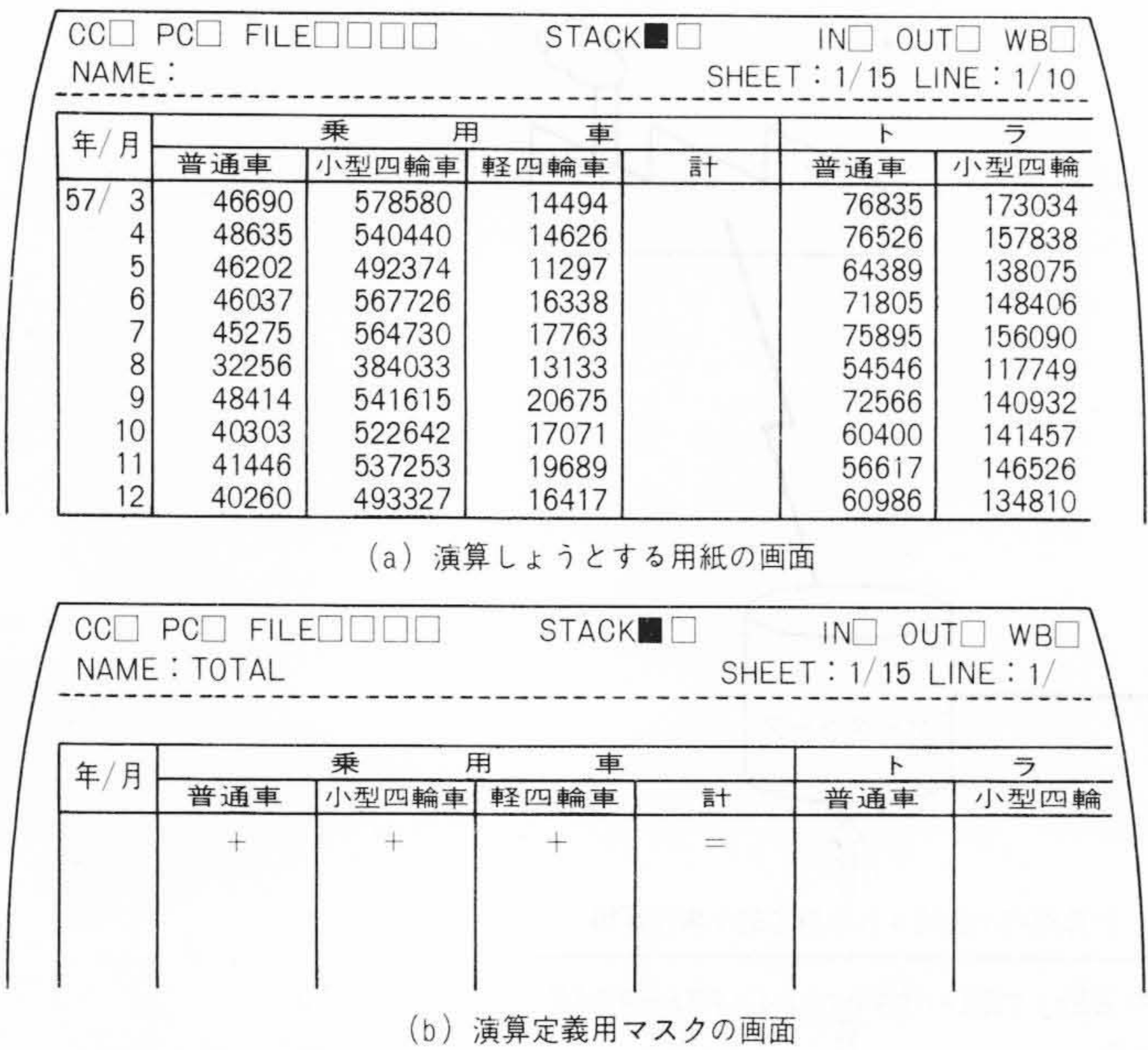
注：出典（「自動車工業」1983, Vol. 17(5)） 図3 用紙データに対する演算指定 (a)で示した用紙のデータに演算指定しようとする時、この用紙の表の枠である(b)がCRTに表示され、これに演算を定義することになる。
