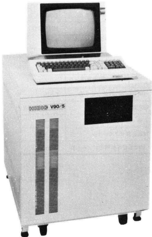
図30 日立制御用スーパーマイクロコンピュータ HIDIC V90/5
