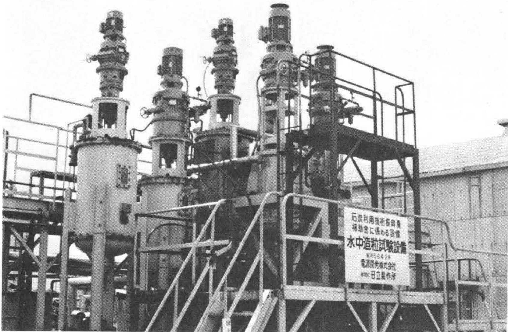
図4 パイロットプラント外観 高速かくはん槽と低速かくはん槽の組合せによって、脱灰率の高い良質な造粒炭が得られる。
