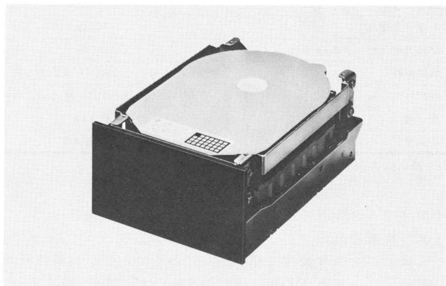
図2 DK511形5.25inディスク装置 DK511形5.25inディスク装置の外観を示す。
