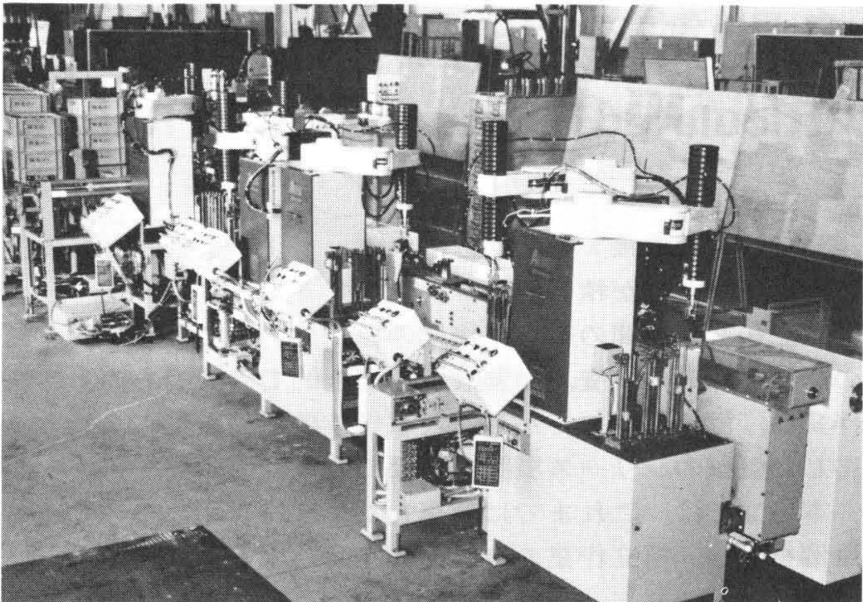
図2 コンプレッサ部品組立ライン外観 A4010シリーズロボット7台によるコンプレッサ部品の自動組立を行なう。
