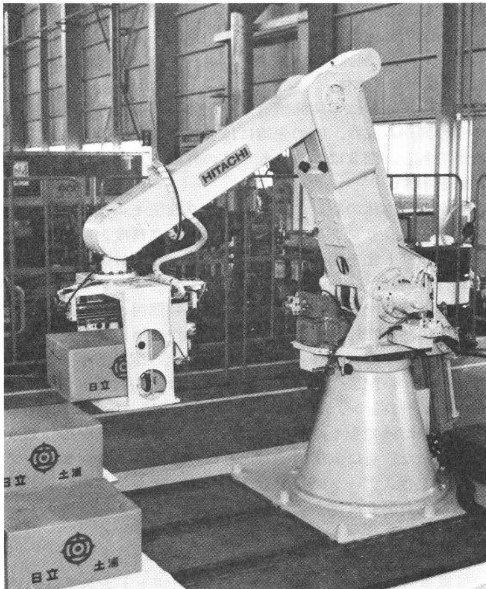
図8 段ボール箱の積載例 図3に示したロボット本体に、段ボール箱用ハンド(約40kg)を取り付け、段ボール箱(20~35kg)を移載している。
