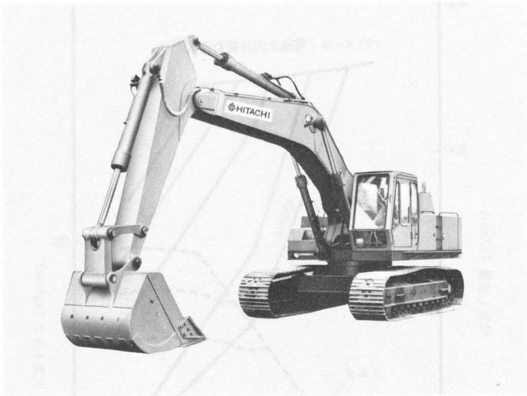
図4 日立UH16マイクロコンピュータショベル 動力系の電子制御により、低燃費化及び作業性向上を図った。
