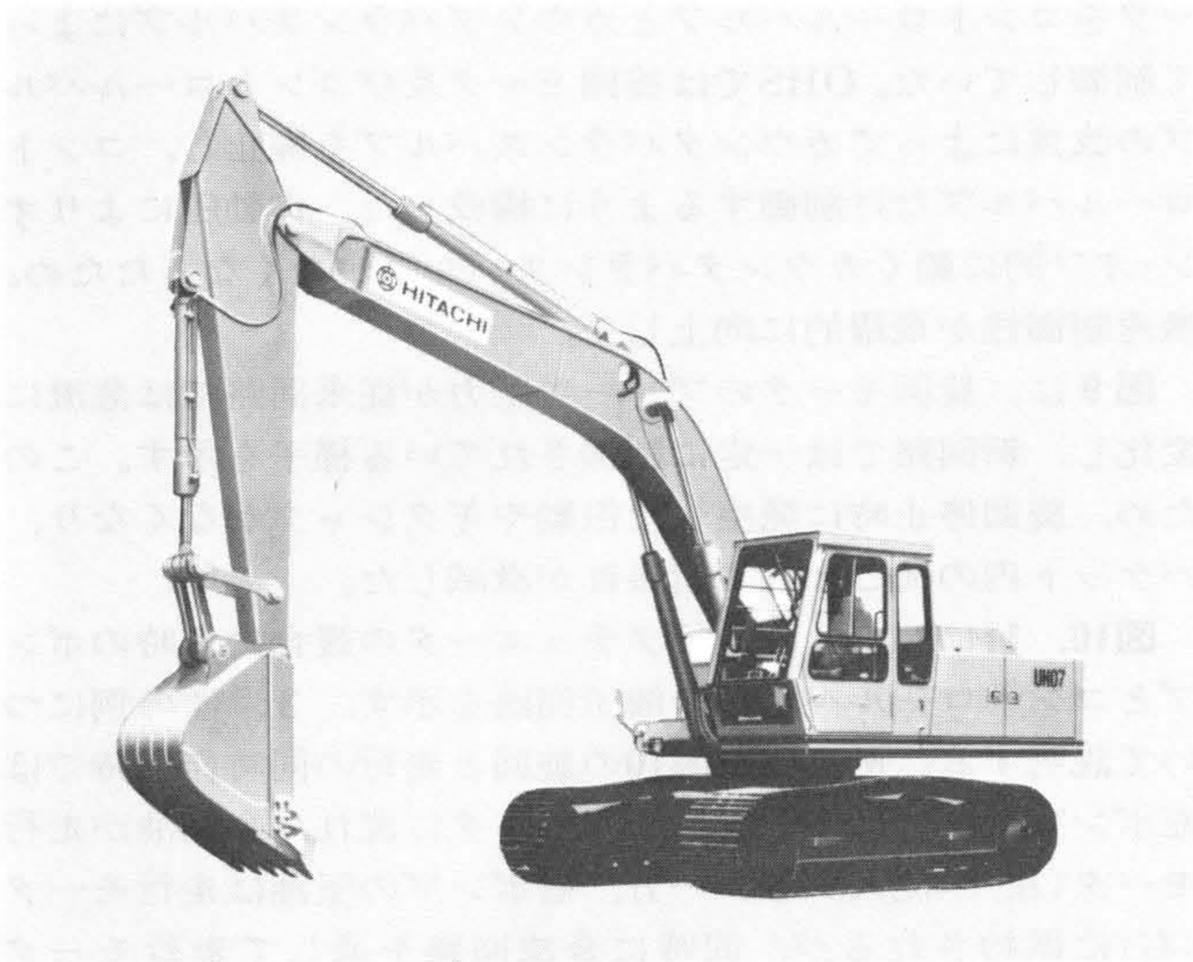
図4 UH07-7の外観 OHS油圧システムを搭載したUH07-7の外観を示す。
