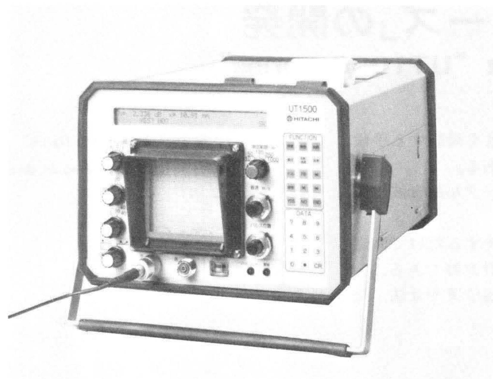
図2 開発装置UT1500超音波探傷器(面圧測定機能付き)の外観 幅240mm×長さ350mm×高さ175mmのポータブルタイプである。重量はバッテリー込みで8.5kgfである。
