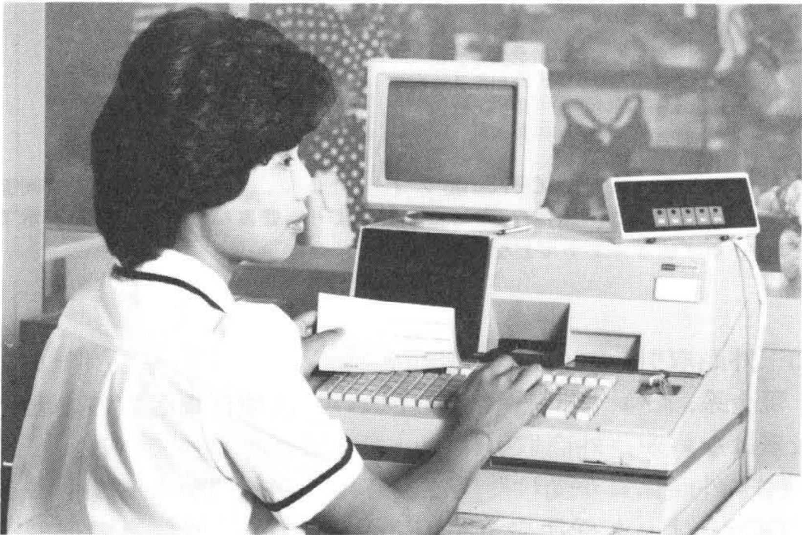
図4 百貨店向けPOSターミナルの外観 9 inのCRTを採用したことにより、オペレータガイダンスが充実し、だれでも簡単にオペレーションが行なえる。
