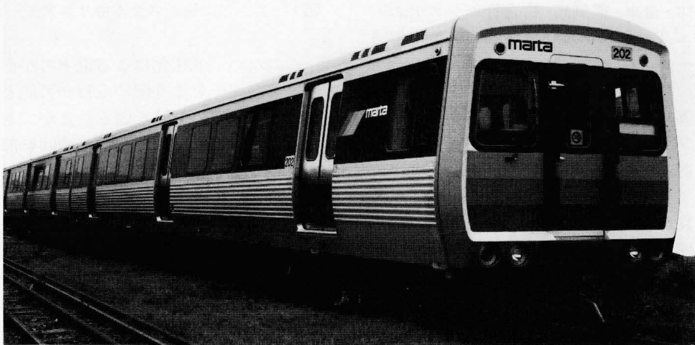
図5 米アトランタ市交通局納め軽量ステンレス製地下鉄電車の外観
