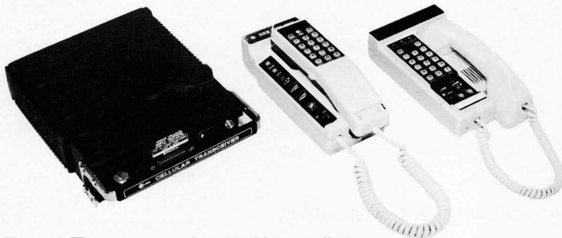
図15 米国向けセルラー自動車電話移動局装置の外観〔トランシーバユニット(左), D形コントロールユニット(中)及びS形コントロールユニット(右)〕
