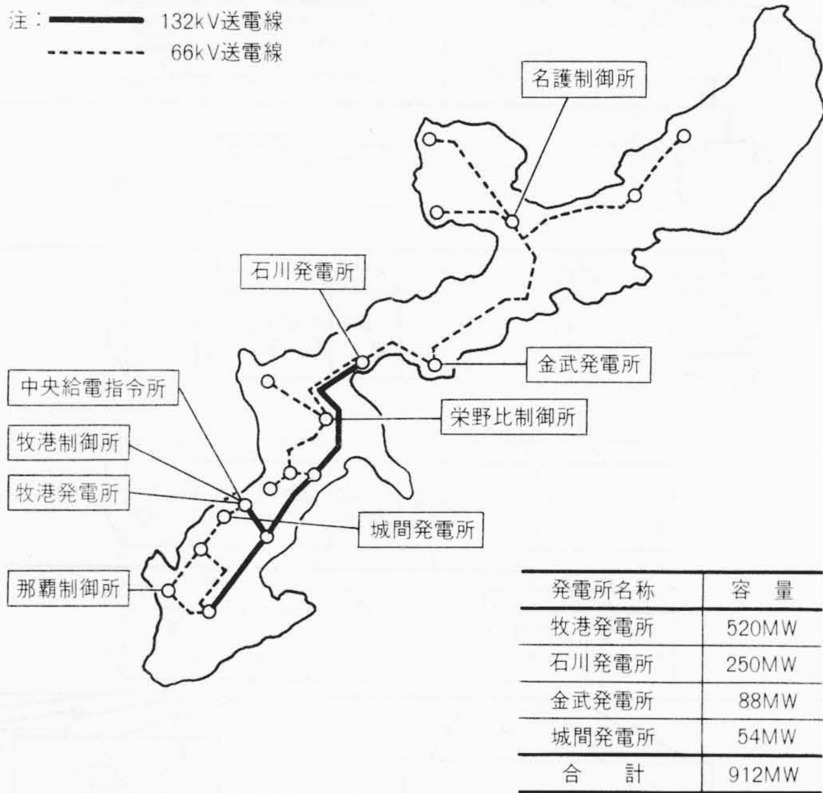
図1 沖縄電力株式会社の送電系統 電力需要の70-80%は那覇を中心とした南部に集中しており、これを支える火力発電の系統容量は912MWである。
