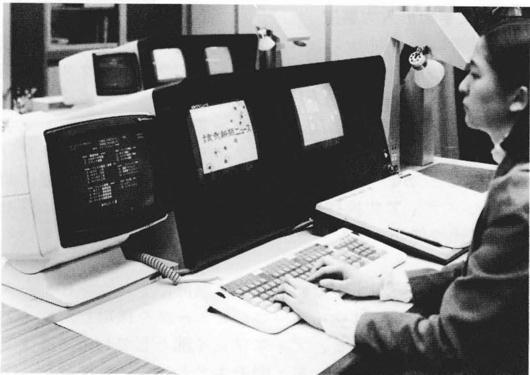
図3 文字図形入力装置の外観 カメラ入力したイラストを、正・副モニタとデータタブレットを利用して図形を作成する。
