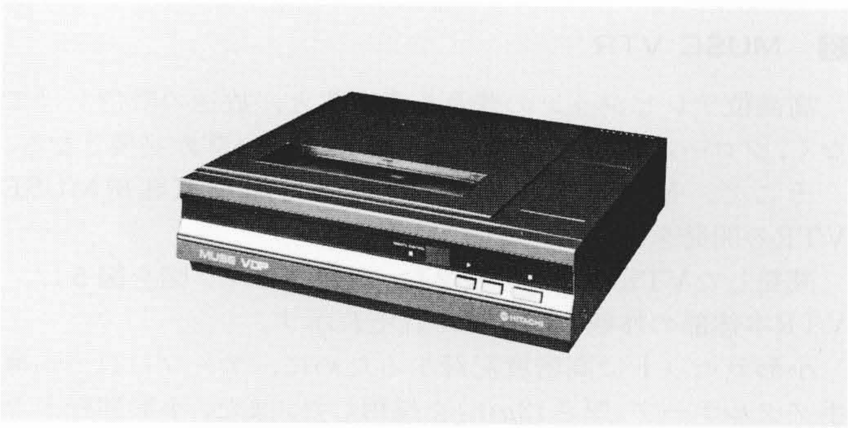
図11 MUSE VDP本体部の外観 光学式ビデオディスク(直径30cm)を用いた家庭用MUSE VDPの試作機を示す。
