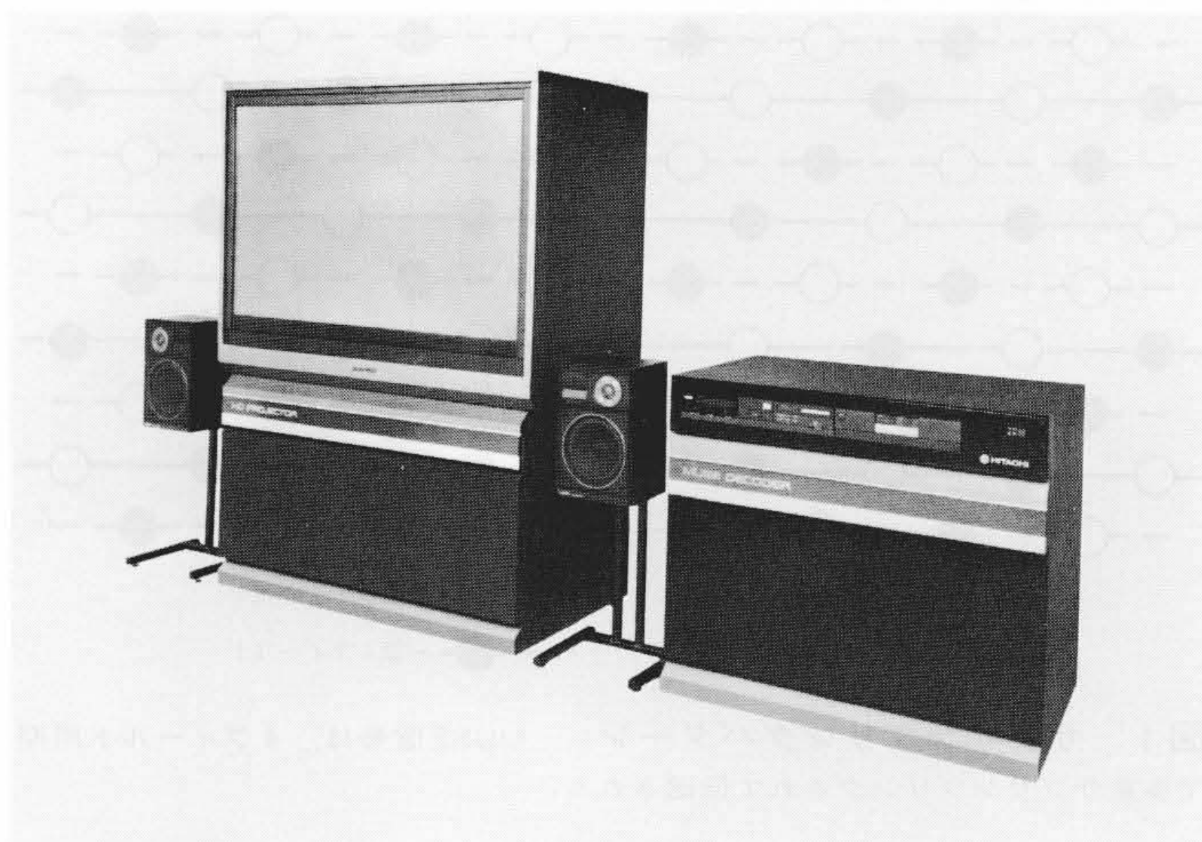
図4 MUSE受信機の外観 MUSEデコーダ(SHF受信機、映像・音声デコーダを含む)、54形リアプロジェクタ及びスピーカで構成している。
