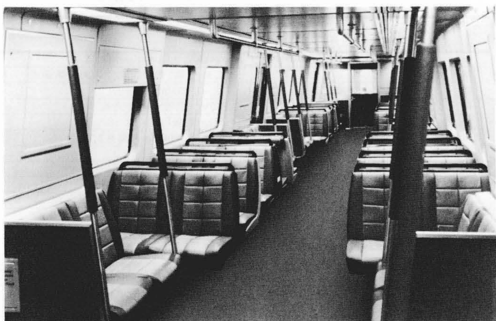
図4 客室内アレンジメント サイドパネルはFRP製、天井はメラミン化粧板サンドイッチパネルの平天井で、空調エアの吐出しはラインフロー式である。腰掛はセミクロスタイプとし、床全面にカーペットを敷いた豪華な造りとなっている。
