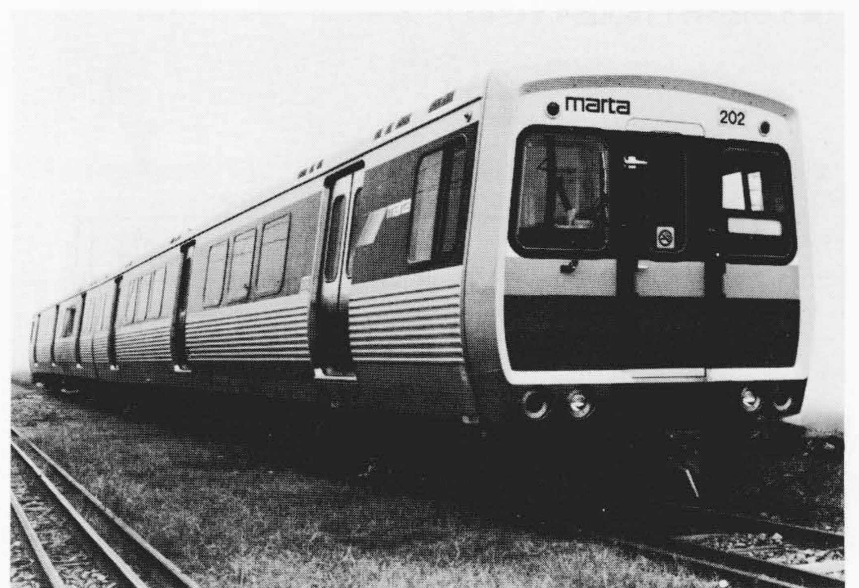
図1 米国ジョージア州MARTA向け電車の外観 前頭の腰部にはブルー、イエロー、オレンジの米国ジョージア州MARTA(アトランタ市交通局)のシンボルカラーを配して、周囲にFRP(ガラス繊維強化プラスチック)製マスクで縁どったアクセントを付け、車体も丸みをもったスマートなデザインとしている。
