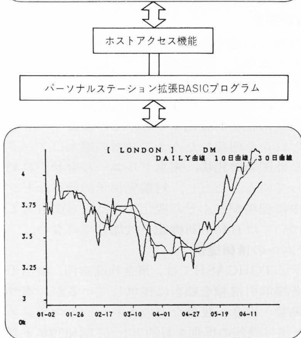
図4 アプリケーション具体例-ユーロ金利推移グラフ オンライン画面で検索したユーロ金利推移データを基に、T-560/20パーソナルステーションホストアクセス機能によりグラフ化を行なう。グラフ化のニーズは多様であるが、グラフ処理は拡張BASICプログラムで行なっているため、容易に対応できる。
