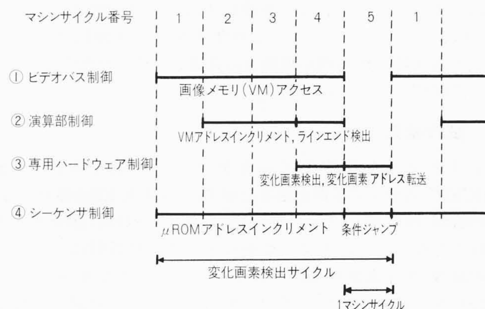
図6 変化画素検出におけるパイプライン処理 画像メモリアクセスサイクルに1サイクル付加するだけで、変化画素検出処理できるパイプラインタイミングを示す。
