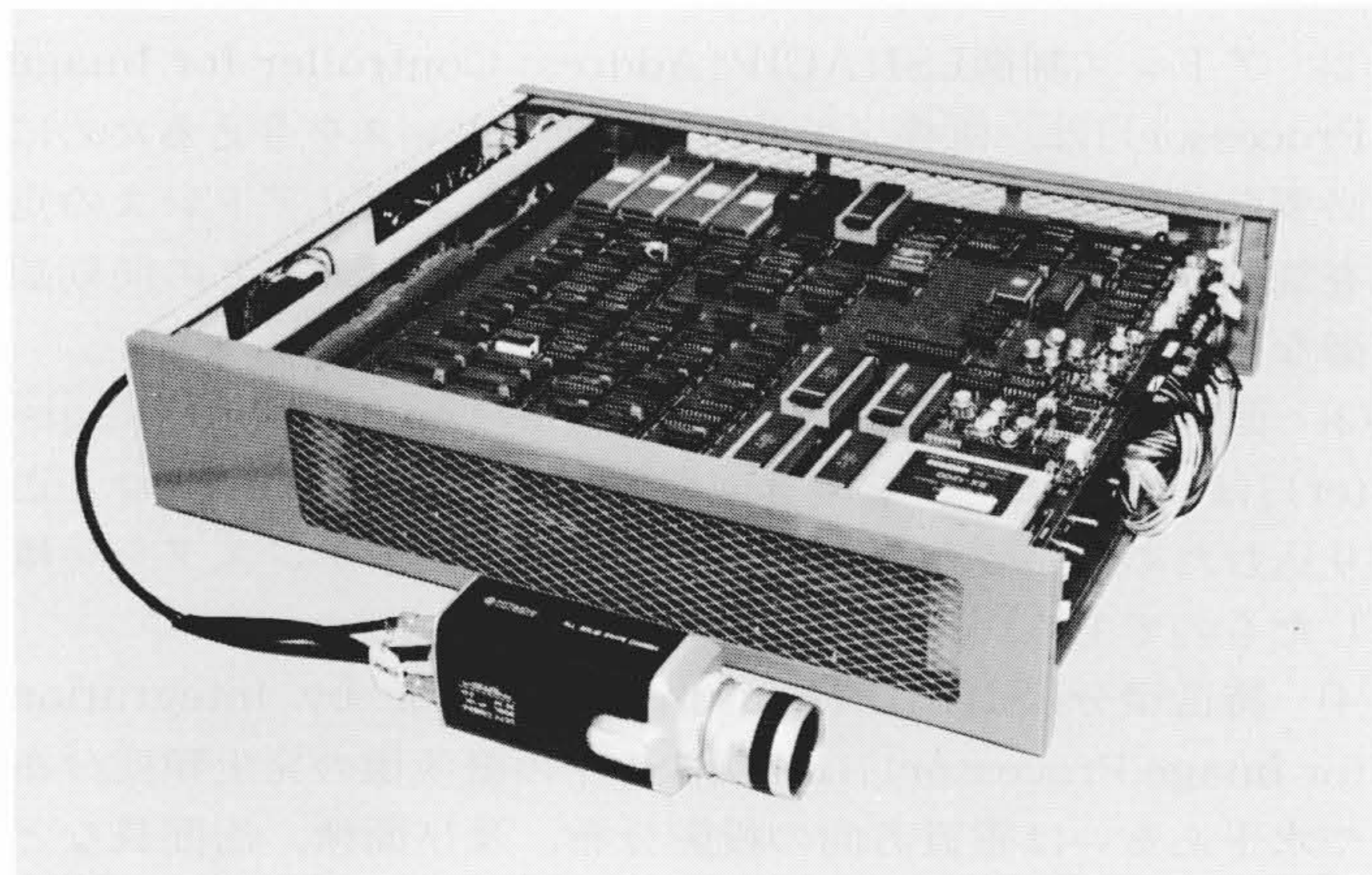
図1 SBIPの外観 画像処理回路のLSI化により、マイクロコンピュータを中心とする制御回路と合わせても、幅40cm、奥行50cm、高さ10cmとコンパクトにまとめることができた。
