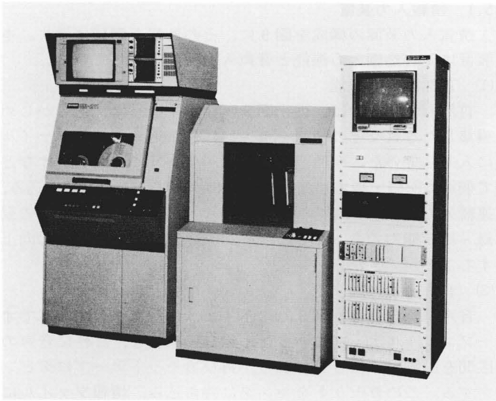
図10 情報入力装置の外観 装置中央に照明付き撮像台とテレビジョン、カメラにより写真などの自然画がワンタッチで能率的に簡単に入力できる。ほかに連続入力用VTR(左側)及び音声入力用テープレコーダ(右側中央)で構成されている。
