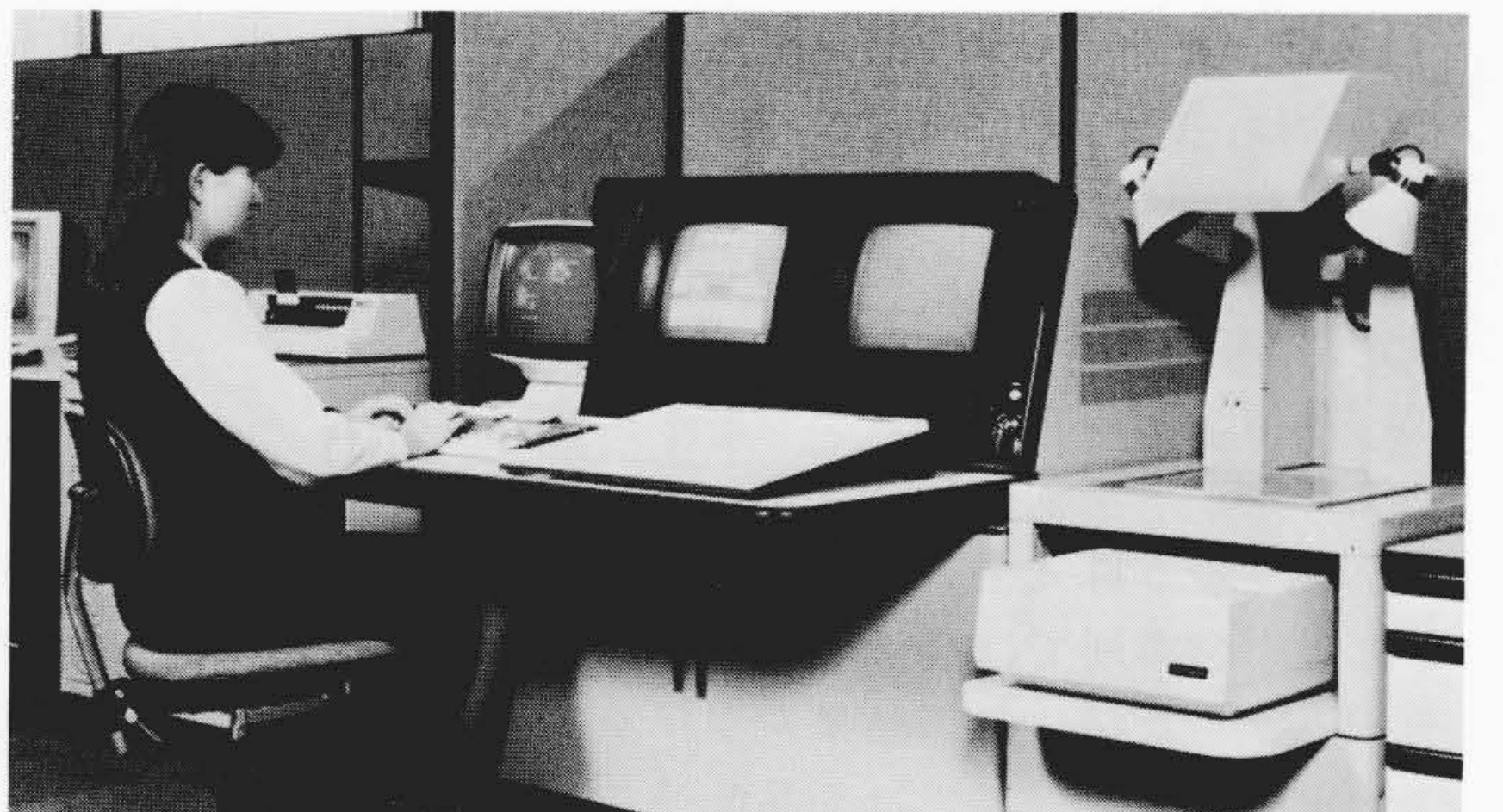
図8 キャプテン用文字図形入力装置(VI-1000C) キャプテンのランク1から5までの文字、図形画面の製作、及びキャプテンセンタへの登録が可能である。
